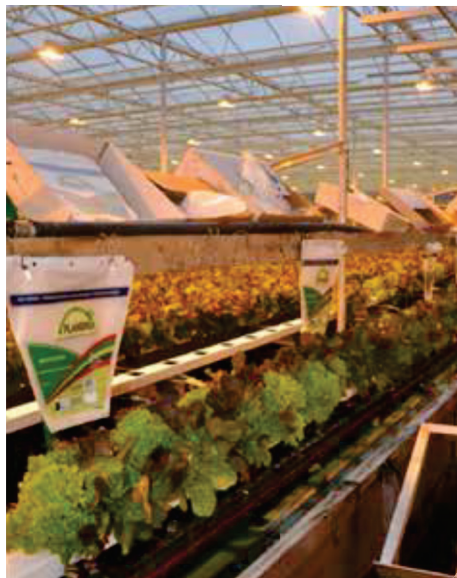
Een goot met oogstklare sla wordt via een transportband naar de oogsttafel gebracht. Na het oogsten worden de goten automatisch gewassen.
